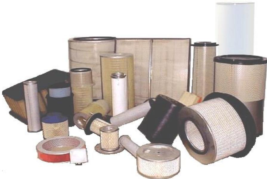
A sua função é reter as partículas sólidas (pó, poluição, insectos, neve...) que existam em suspensão no ar. Devem oferecer a máxima eficácia na retenção das partículas e, por sua vez, a mínima resistência ao fluxo de ar, otimizando a injeção e reduzindo o consumo. A matéria filtrante utilizada é, na grande maioria das aplicações, papel de celulose, a 10 $\mu$ .
